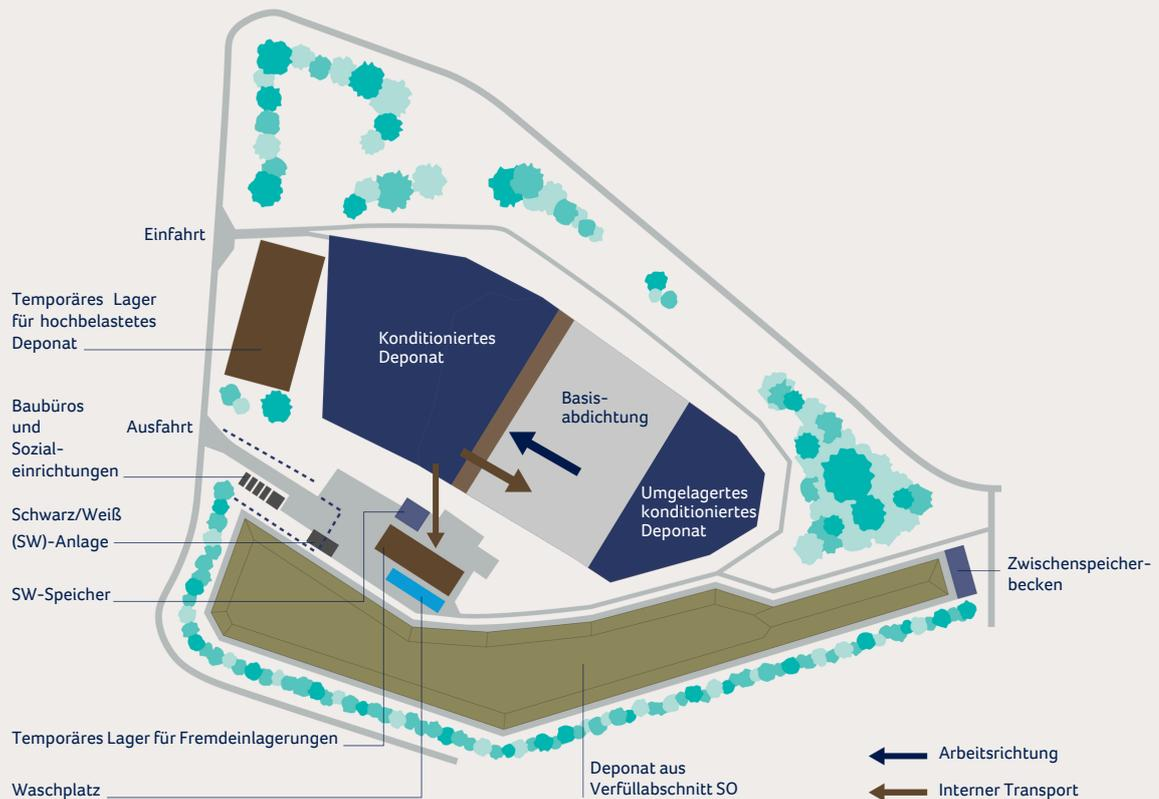
Am Ende der Sanierungsphase 4 ist das gesamte Deponiegebiet mit einer grundhaften Basisabdichtung versehen, alle Fremdeinlagerungen sind vollständig entfernt und extern entsorgt worden, das verbleibende Deponiematerial ist vollständig aufbereitet und auf der Abdichtungsfläche platziert. Während der Phasen 2 und 3 wird die geologische Barriere (ein natürlicher Schutz gegen das Durchsickern von Schadstoffen) vollständig freigelegt, überprüft und durch eine zusätzlich technische Barriere ergänzt.
